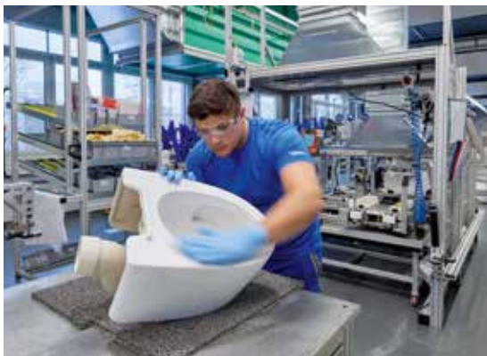
Montage von Dusch-WCs ...
